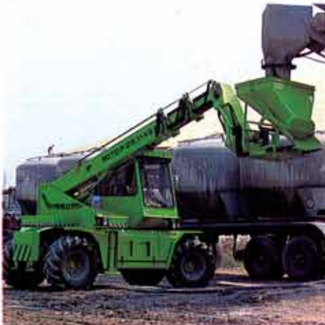
Beladen, Transportieren und Eingießen von Beton. Zubehör: Beton-Kübel
