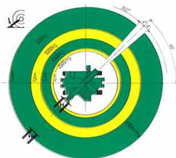
DIE TRAGKRAFT IST ANGEZEIGT BEI 500 MM LSP, DIE WERTE DER MASCHINE GELTEN AUF EBENEM GELÄNDE.
