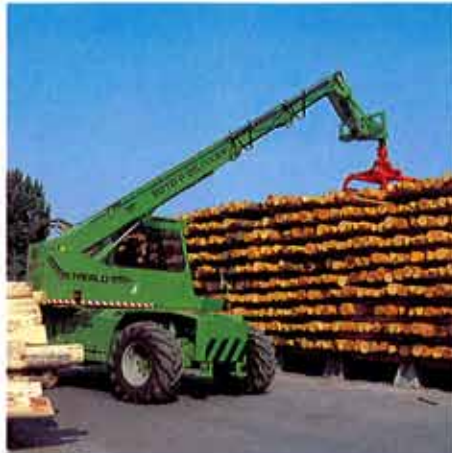
Laden und sortieren Stämmen. Zubehör: Holz-Greifer
