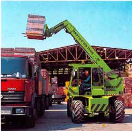
Umschlag von palettierter Ware auch in schwer zugänglichen Bereichen. Zubehör: Palettengabeln mit Pin-type-Aufnahme
